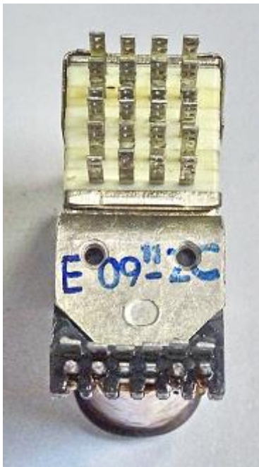
pohľad na kontakty telefónneho valcového relé
