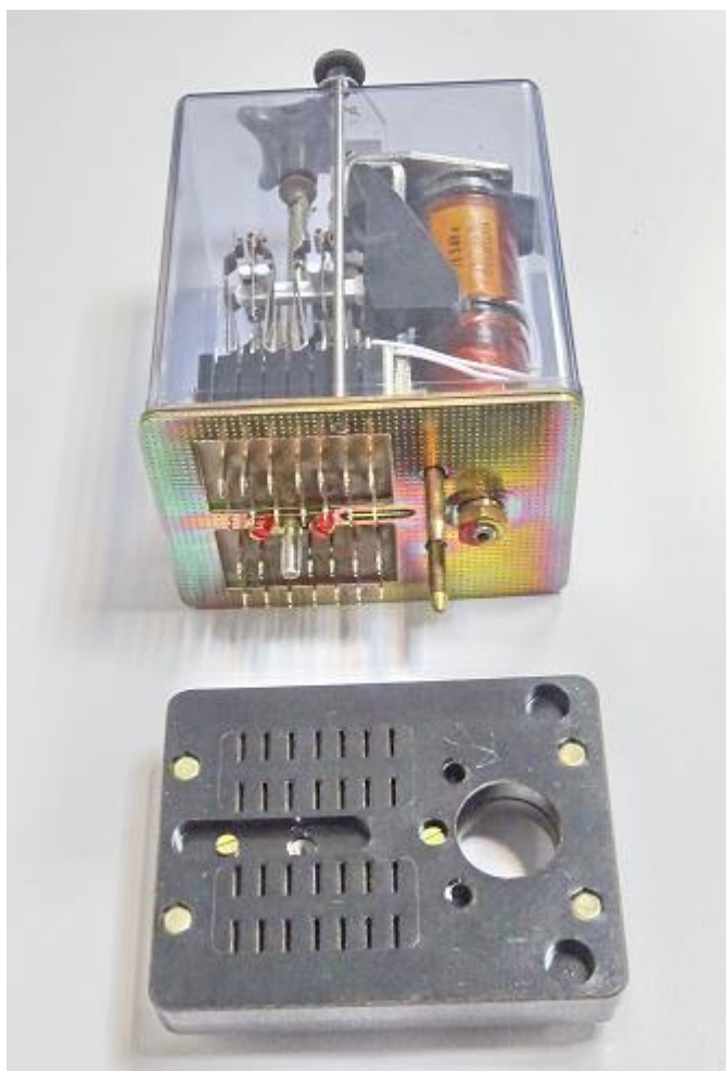
panelová zásuvka (svorkovnica) a relé vytiahnuté zo zásuvky
