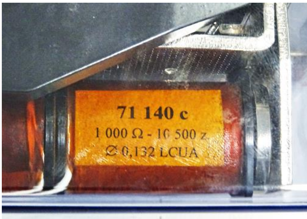
pohľad na jednu z cievok relé – vinutie má odpor 1 000 Ω, 10 500 závitov priemeru 0,132 mm
